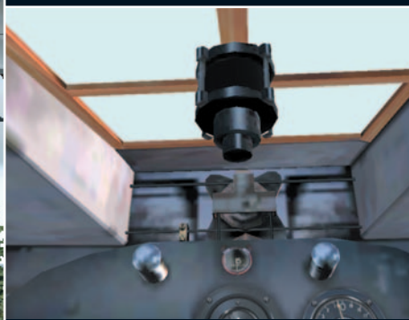
■ El Spirit of St. Louis cuenta con un periscopio instalado en la cabina.
